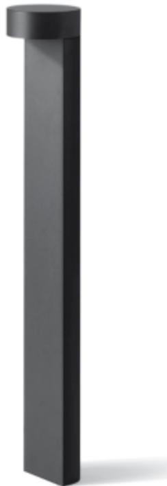
Gute Gestaltung und hoher Sehkomfort kennzeichnen auch diese **LED-Garten- und Wegeleuchten mit abgeblendetem gerichtetem Licht**. Das Licht ist auf die Bodenfläche gerichtet. Gestalterisch passende Wandleuchten finden Sie auf Seite 22. Empfohlener Lichtpunkt Abstand dreieinhalb Meter
