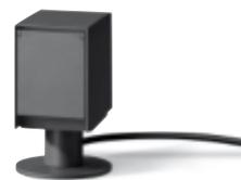
Die **ortsfesten Anschlussssäulen** stehen wahlweise mit **zwei oder drei Schutzkontaktsteckdosen** zur Verfügung. Sie sind jeweils auf einer Seite der Säule platziert. Zur ortsfesten Montage der Anschlussssäulen werden diese wahlweise mit einem Erdstück aus feuerverzinktem Stahl oder mit Aufschraubsockel zur Befestigung auf einem Fundament geliefert.
